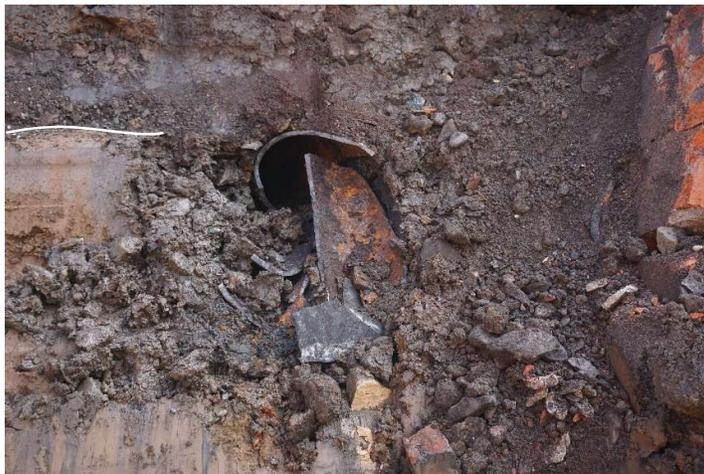
Abb. 24: Ölgetränkte Bettung aus Grobschlag einer alten Rohrleitung südlich des Oberleitungsmastens 1 in den hangenden Anteilen des Hochflutlehms (weiße Linie: Schichtgrenze zwischen Auffüllung und Hochflutlehm)
