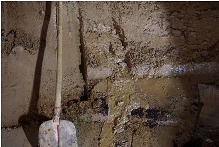
Abb. 17: Austretendes (mobiles) Öl aus einer Sandlage innerhalb des Hochflutlehms (Nachtaufnahme)
